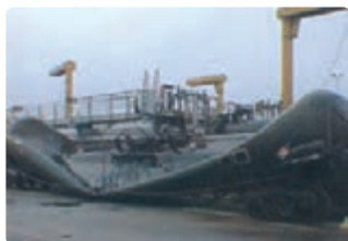
شکل ۴-۳۷ سرد شدن هوای درون مخزن باعث کاهش فشار این هوا و در نتیجه مجاله شدن مخزن شده است.
